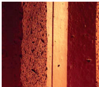
Рис. 6. Поризованная структура черепка
